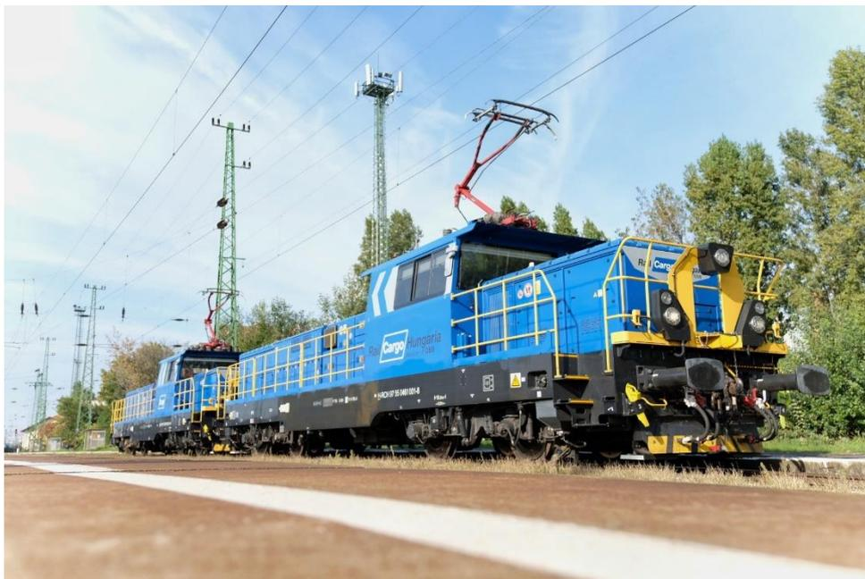
*Verschublokomotiven der RCH mit Elektro-Hybrid-Technologie*
