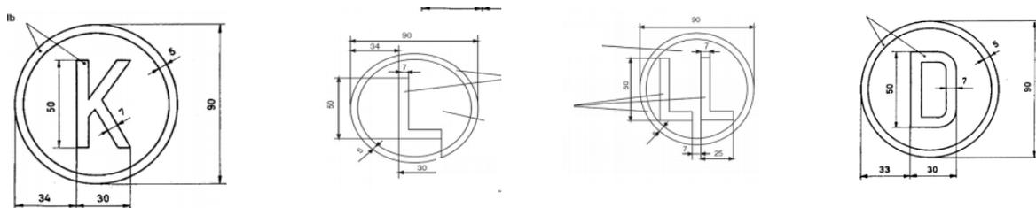
Die obigen Sonderzeichen befinden sich an beiden Seiten der Wagen unmittelbar rechts von der Bremsbauartanschrift (der Löseeinrichtung an der Umstelleinrichtung für Druckluftbremsen). Die Farbe der Anschriften variiert von Elfenbein bis Gelb.
