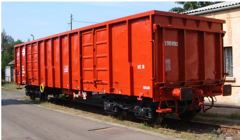
Hagyományos, normál építésű, 4 tengelyes nyitott kocsik. A kocsik mindkét oldala 2-2 oldalajtóval felszerelt. A kocsi nyitható homlokfalú.
