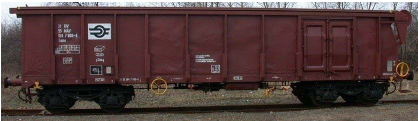
Különleges építésű 4 tengelyes, elhúzható ponyvatetős, magas oldalfalú kocsi. Alkalmos időjárás hatásaira érzékeny ömlesztett, illetve darabos áru fuvarozására.
