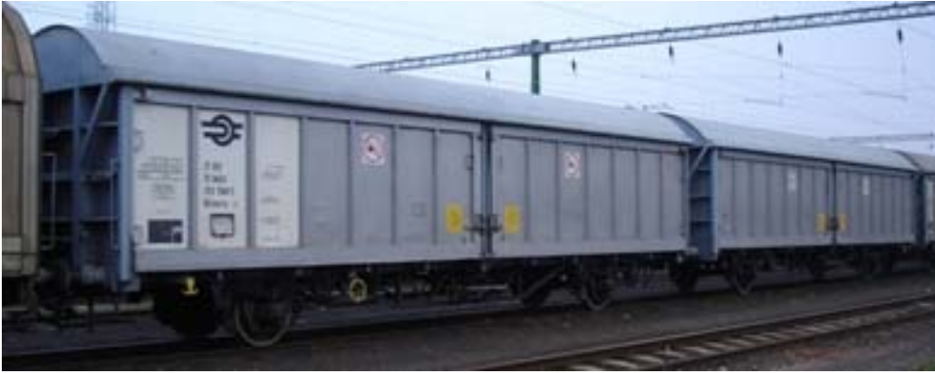
Különleges építésű 2 x 2 tengelyes „iker”, eltolható oldalfalú fedett kocsi, kocsinként 2-2 db válaszfalal felszerelt
